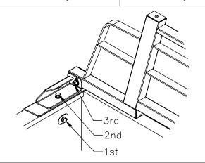
TIGHTEN THE FASTENERS IN THE SEQUENCE SHOWN.
